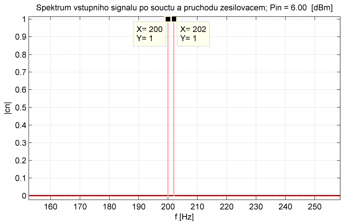
Obr. 10 Spektrální charakteristika vstupu – pro nižší výkon – je vidět snížení amplitudy složek
